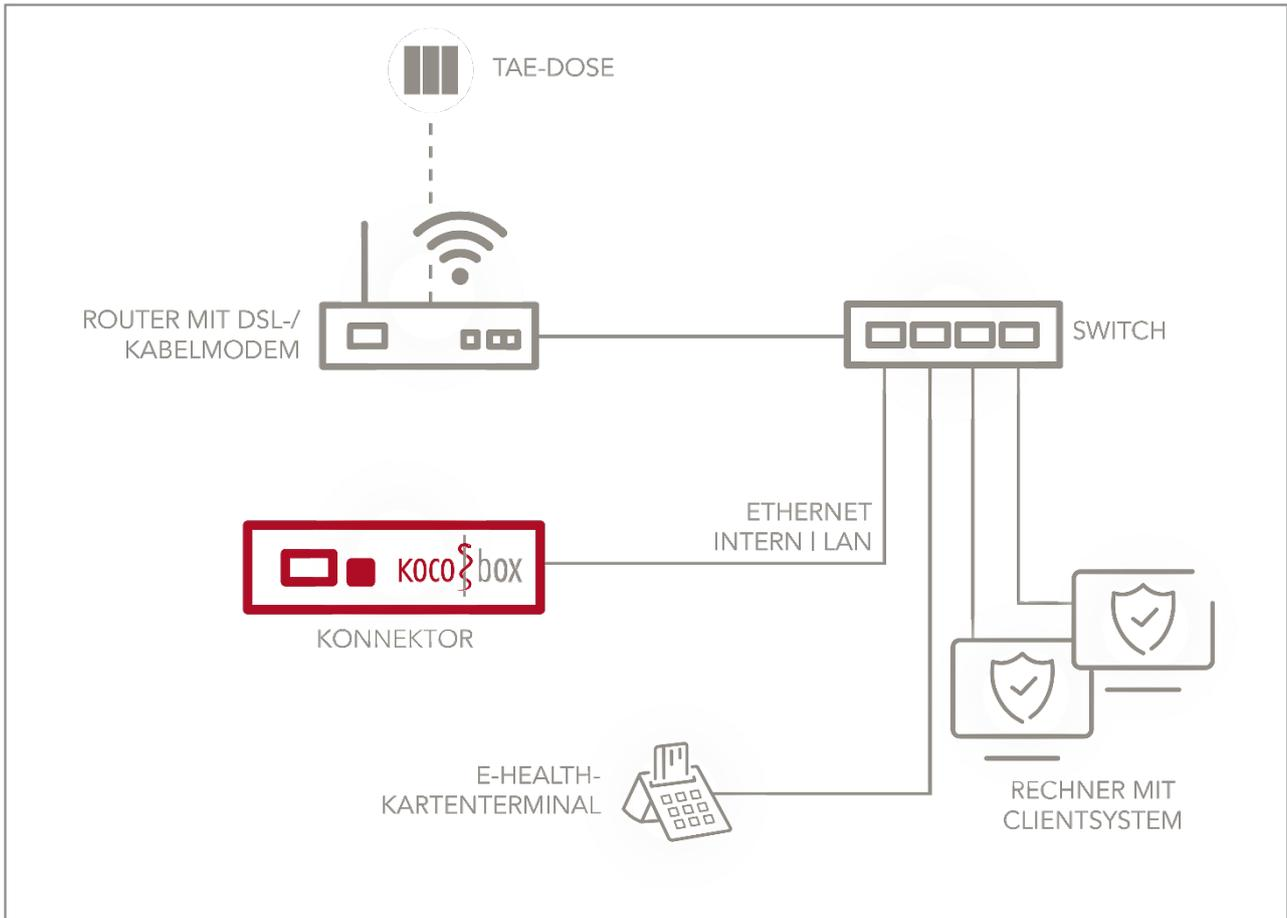
Abbildung 25: Parallele Anbindung der KoCoBox MED+
