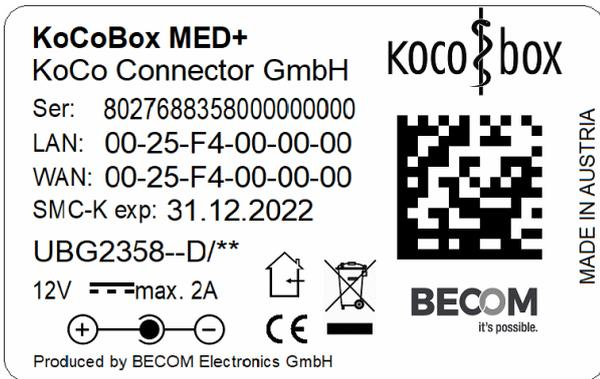
Abbildung 22: Typenschild am Boden der KoCoBox MED+ (G3)
