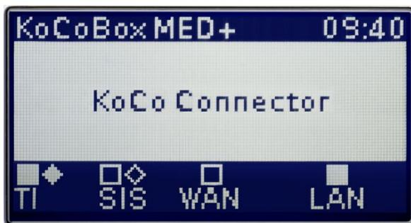
Abbildung 43: Display der KoCoBox MED+ nach der Initialkonfiguration (G3)
