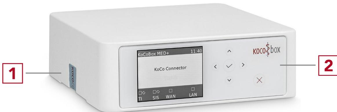
Abbildung 15: KoCoBox MED+ (G4) Ansicht links mit Sicherheitssiegel
