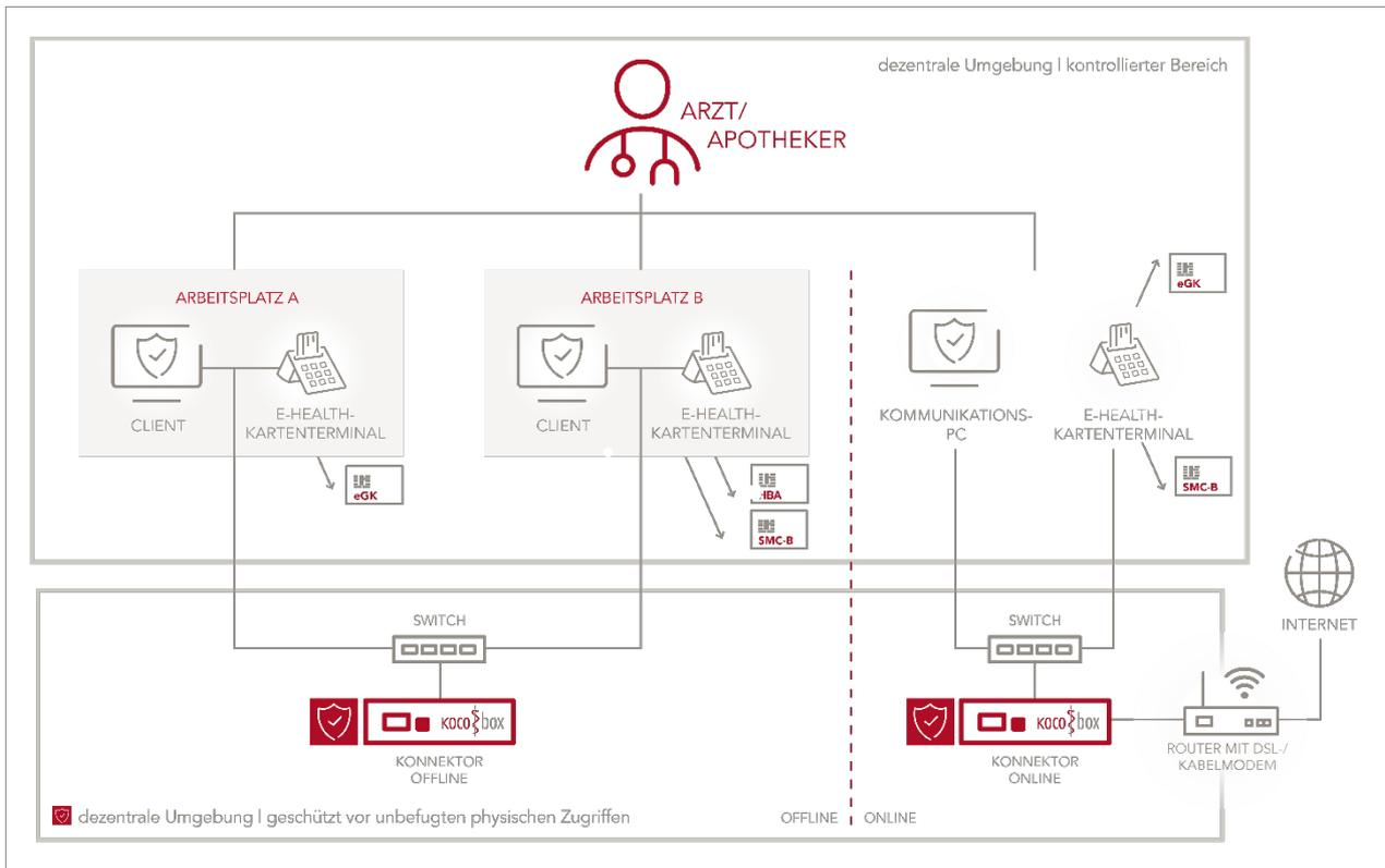
Abbildung 134: Einsatz der KoCoBox MED+ Standalone mit physischer Trennung der Konnektoren
