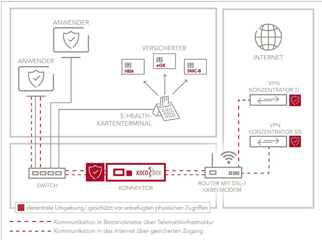
Abbildung 131: Szenario für die einfache Installation der KoCoBox MED+
