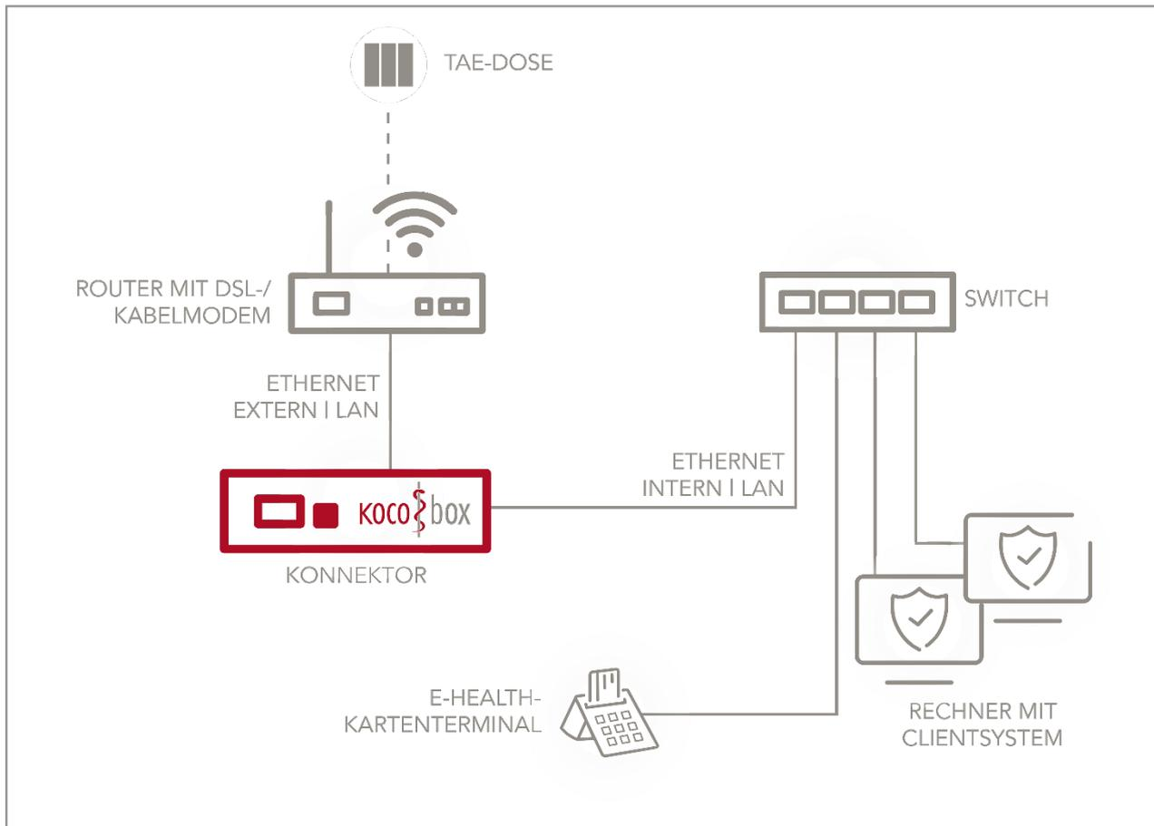
Abbildung 24: Serielle („in Reihe“) Anbindung der KoCoBox MED+
